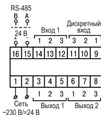
Рисунок 5.5 – Общая схема подключения TRM10–Щ5
