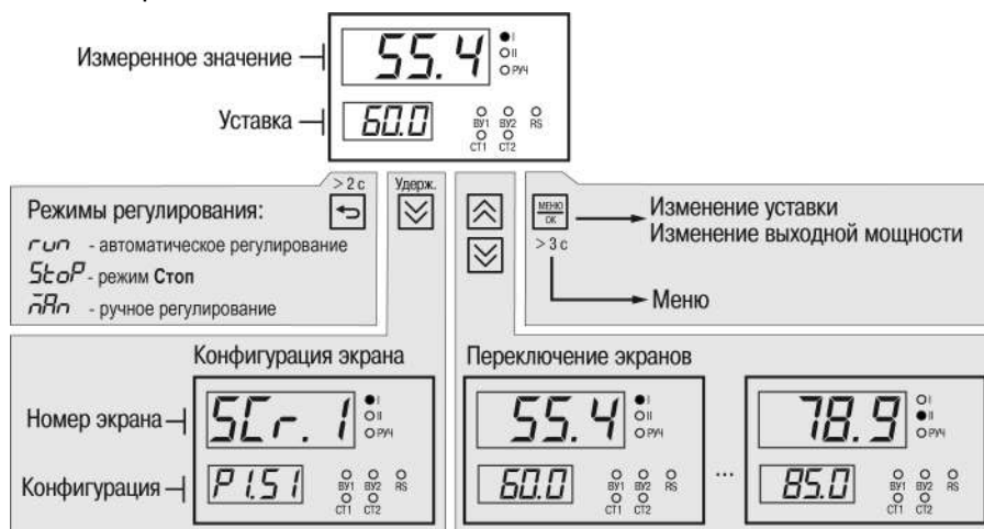
Рисунок 6.5 – Схема переходов с главного экрана
