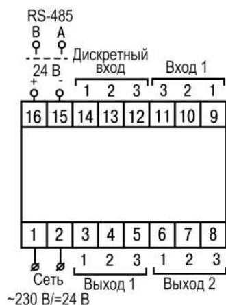
Рисунок 5.6 – Общая схема подключения TRM10–Д
