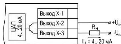
Рисунок 5.22 – Подключение к ВУ типа «И»
